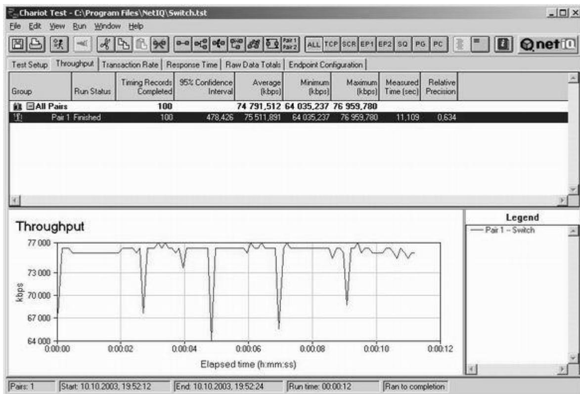
Рисунок 3.3 - Тестирование производительности коммутации
