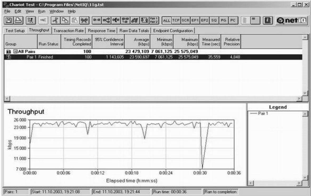
Рисунок 3.1- Тестирование беспроводной части при условии 1 (без WEP)
