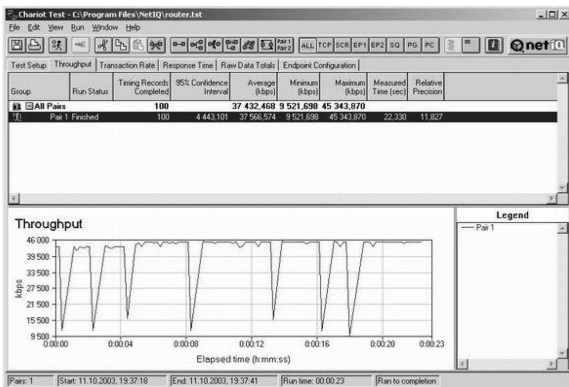
Рисунок 3.4- Тестирование маршрутизатора в направлении LAN-WAN
